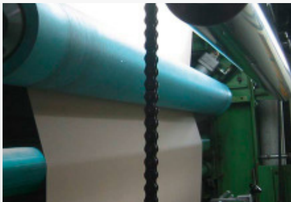
Folienkaschieranlage mit MITEX UltraClean Reinigungswalzen Foil lamination machine with MITEX UltraClean cleaning rollers
