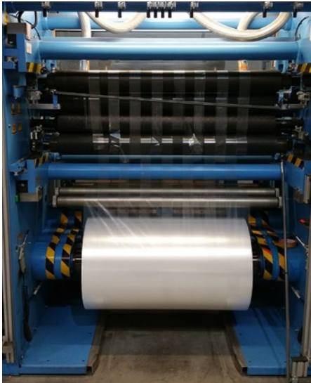
Sandwichwalze und SoftSpreader liefern im Verbund ein optimales Schneidergebnis
