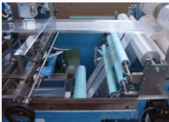
Beidseitige Reinigung empfindlicher Folien Face and underside cleaning of sensitive foils
