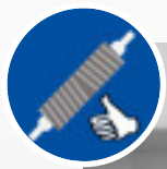
Lokale Dehnung empfindlicher Folie auf hinterschnittenen Breitstreckern
